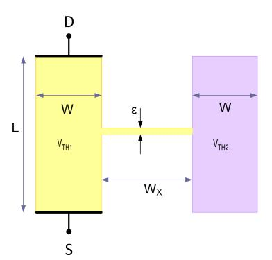
$$\begin{split} I_D &\simeq \frac{\mu C_{OX}W}{2L} \Big(V_{GS} - V_{TH1}\Big)^2 \\ V_{THEQ} &= \frac{\int\limits_A^{} V_{TH} \big(x,y\big) dx dy}{A} \simeq \frac{V_{TH1} + V_{TH2}}{2} \\ &\text{If } V_{TH1} = 1V, \ \ V_{TH2} = 2V \\ V_{THEQ} = 1.5V \end{split}$$
